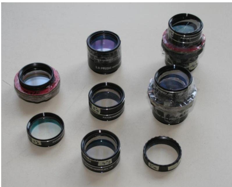
Bild 2: Prismen und Gitter in Fassungen sowie fertige Gitter/Prismenkombinationen
