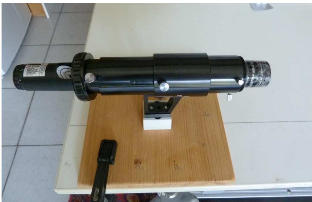
Bild 3: PGP in 1,25" – Steckhülse mit Befestigungsvorrichtung und Laserkollimator
