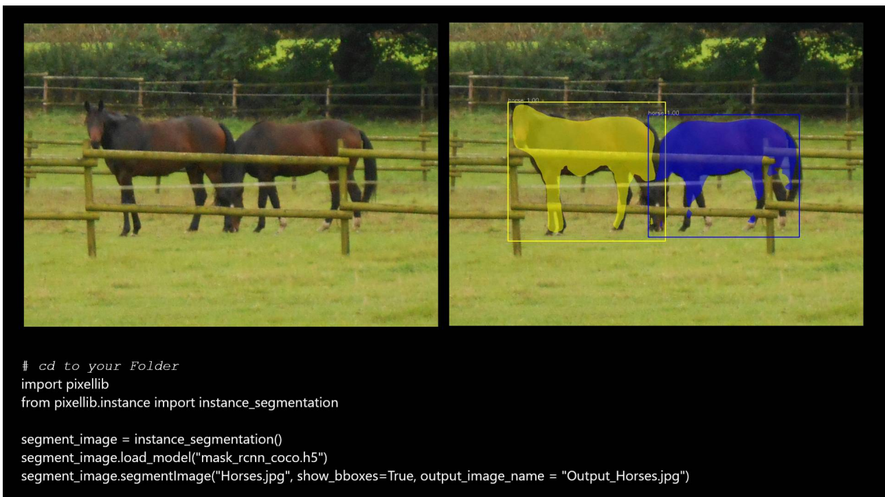
Figure 2 – Mit dem Netzwerk mask_rcnn_coco werden zwei Pferde erkannt. Nur ein sehr kurzer Code wird dazu benötigt. (Das Foto wurde vom Autor aufgenommen.)
