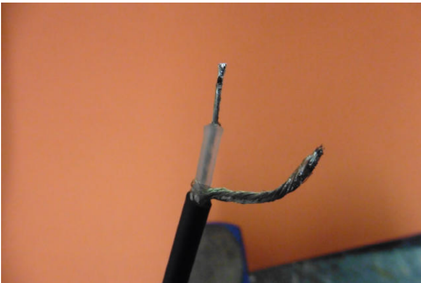
Wichtig: Innenleiterisolierung überstehen lassen, damit kein Kurzschluß mit Abschirmung passiert
