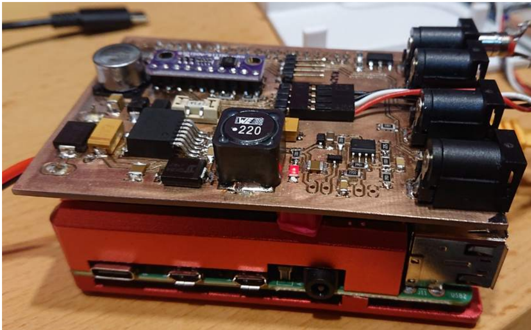
AstroRaspi4 Version2 Prototyp 1 - Aufsatzplatine 1x Dauerplus + 3x NF PWM Kanäle
